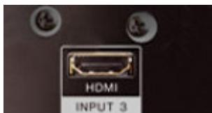
HDMI = High Definition Multimedia Interface. Es überträgt Bild und Ton ausschließlich digital über ein Kabel inklusive Kopierschutz.
