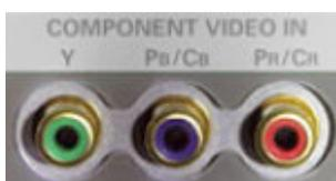
YUV Pr-Anschluss für analoge Video-Komponentensignale.
